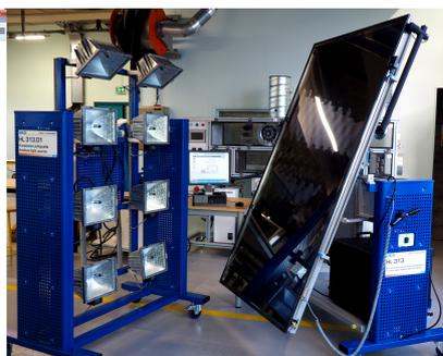
**Financement d'un panneau solaire thermique avec système d'éclairage artificiel et interface logicielle**
